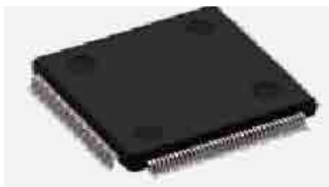
Рис.4 Конструктивная реализация NeuroMatrixR NM6404
